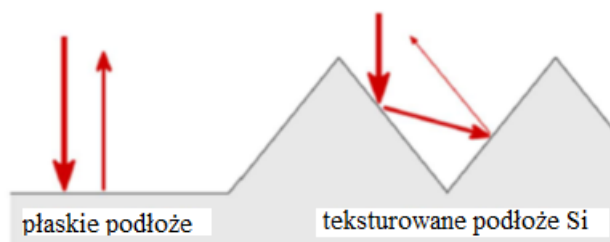
Rys. 13. Ilustracja zmniejszenia współczynnika odbicia na powierzchni teksturowanej (rys. na podst. 11 ).
